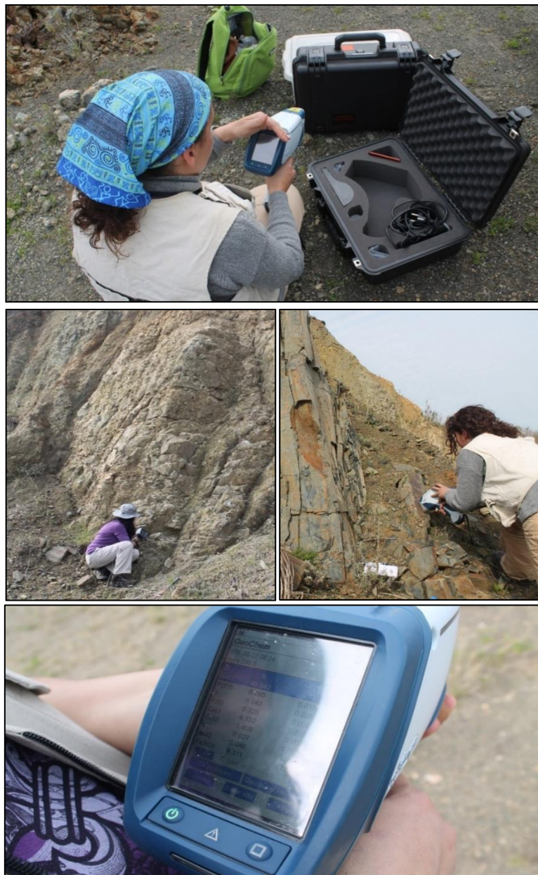
Figura 18. Aplicación del XRF portátil.
